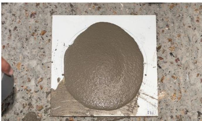
Valider le mélange par un auto-contrôle selon le test au **cône HAGERMANN** (la valeur d'étalement doit se situer entre 180 et 220 m/m).
